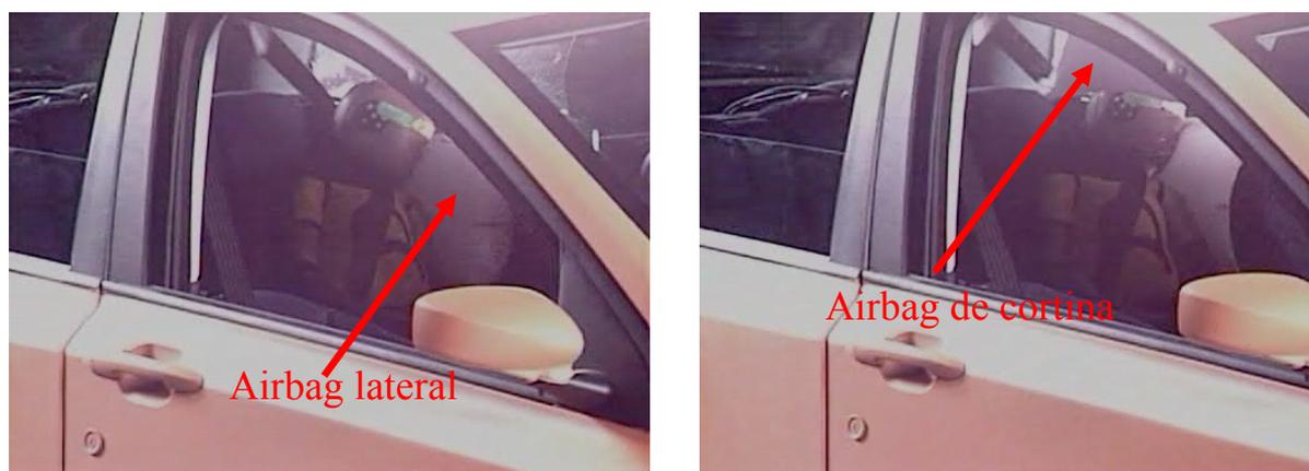
Fig.3: SRI elevador montado para un ensayo con airbags de cortina y laterales
