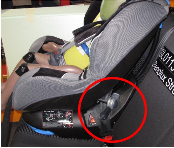
Fig.4: Mecanismo de ajuste de la Renolux Stream
