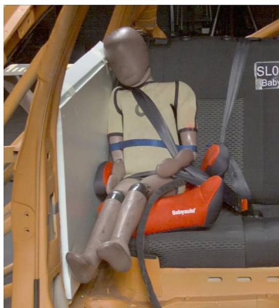
*Fig.2: Babyauto Sinar en el ensayo de impacto lateral. La cabeza y el pecho del dummy no están protegidos y golpean fuertemente contra la puerta*
